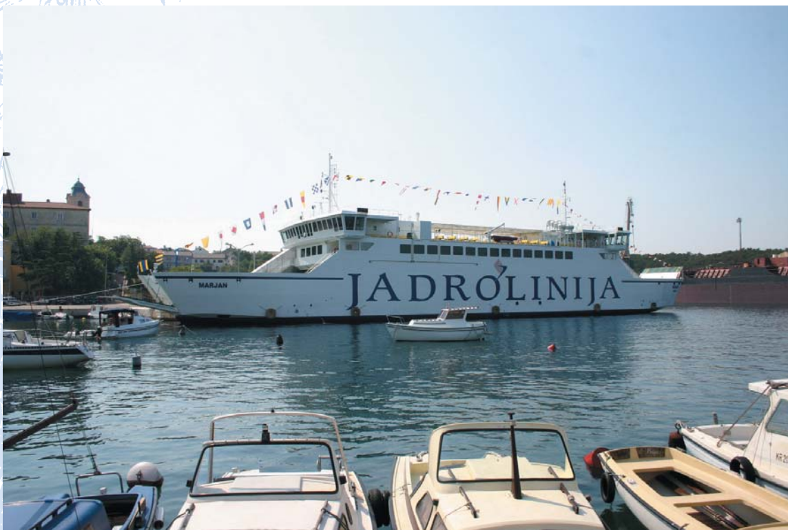
M/b »Marjan« Jadrolinije, Rijeka – najveći trajekt izgrađen u hrvatskim brodogradilištima za domaćeg broдача kapaciteta 130 vozila i 1200 putnika iz programa obnove i razvoja putničke flote Jadrolinije 2004.–2008. uz državni poticaj
